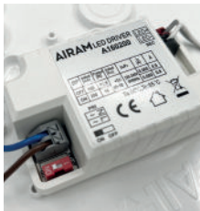
Pir-mallin säätö dip-kytkimellä.
